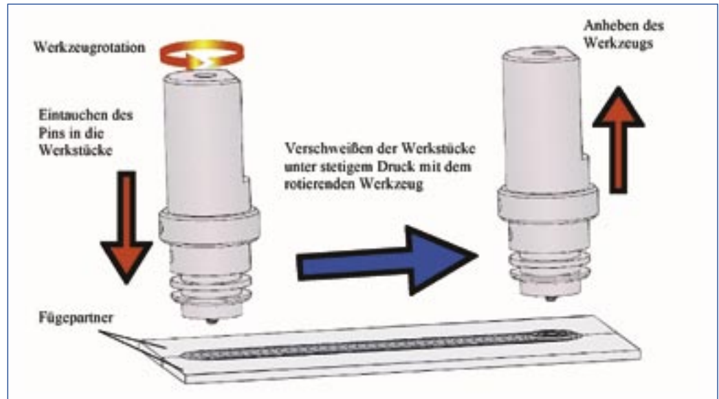
Abb. 1. Verfahrensprinzip des Friction Stir Welding
