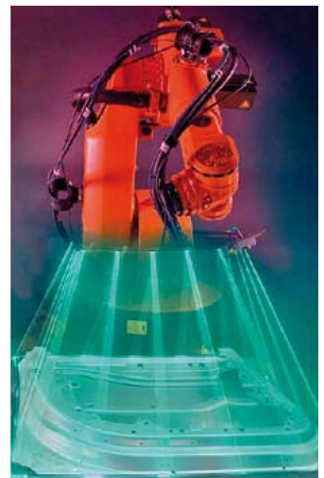
Abb. 1: Strahlführung mit einem Industrieroboter ohne Scanneroptik
