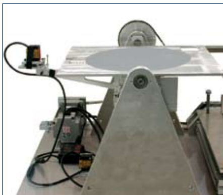
Abbildung 1: 1-dimensionaler Ansatz zur berührungslosen Positionierung von Wafers
